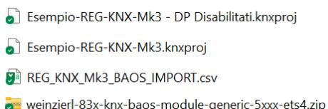
Il modulo KNX contenuto all'interno dell'interfaccia REG-KNX-Mk3 può essere programmato in modo rapido importando nello stesso la configurazione del sistema REG fornita da Setecna (file REG\_KNX\_Mk3\_BAOS\_IMPORT.csv, eventualmente modificato per adattarlo alle caratteristiche della specifica installazione). L'importazione del file .csv deve essere effettuata ricorrendo all'applicazione per ETS denominata “BAOS CSV Importer”, liberamente scaricabile da internet.
