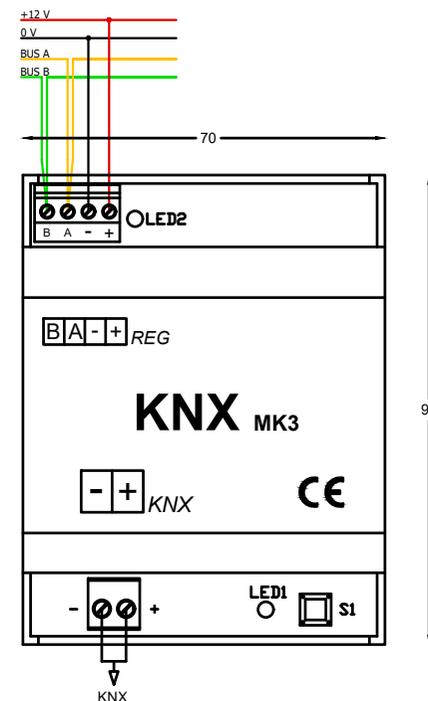
**Attenzione!** Operare sui collegamenti elettrici sempre e solo con modulo disalimentato. Assicurarsi che il voltaggio dell'alimentazione (filo nero "-" e filo rosso "+") sia conforme a quello richiesto dal modulo. I fili giallo e verde devono essere collegati alla comunicazione del sistema REG rispettando il collegamento "entra-esci".
