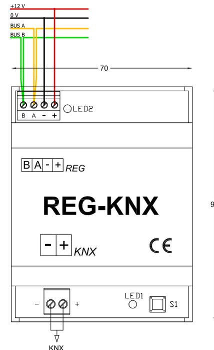
**Attenzione!** Operare sui collegamenti elettrici sempre e solo con modulo disalimentato. Assicurarsi che il voltaggio dell'alimentazione (filo nero "-" e filo rosso "+") sia conforme a quello richiesto dal modulo. I fili giallo e verde devono essere collegati alla comunicazione del sistema REG rispettando il collegamento "entra-esce".
